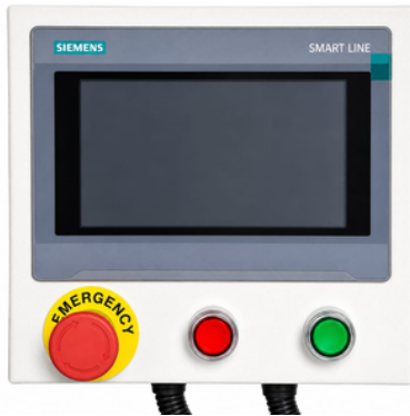
Pantalla táctil Siemens y controles de seguridad
